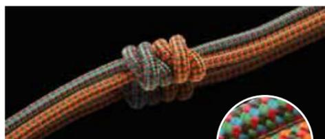
**Tech Cord** ist ein extrem festes und abriebbeständiges Seil Mehrzweckseil. Sein Polyester-mantel umgibt einen parallelen Faserkern aus 100% Technora. Das Resultat: ein Seil mit höchster Zugfestigkeit. Durch Verwendung mit einem Knoten kann die angegebene Zugfestigkeit von Tech Cord, wie bei jedem anderen Seil auch, erheblich reduziert werden. Als Knoten für dieses Seil ist vor allem ein doppelter Spierenstich zu empfehlen.
